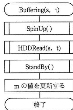
図5 サブルーチン Buffering(s, t) の流れ図
